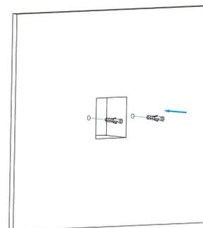
Вставьте в отверстия два дюбеля из комплекта.
