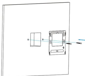
Используйте два винта ST4X20, чтобы привинтить рамку к стене.
