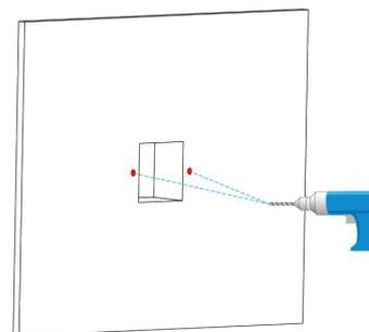
Снимите рамку, затем сделайте два отверстия под крепления диаметром 5мм на отмеченных ранее точках.
