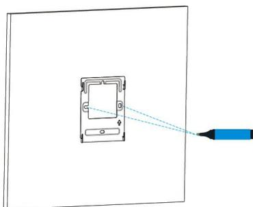
Отметьте два отверстия для фиксации на стене через рамку, расстояние между ними - 60мм. Убедитесь, что все кабели вмещаются в центральное отверстие в рамке.
